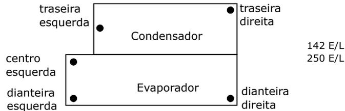
Os apoios de mola são normalmente embarcados montados e prontos para serem instalados. Para instalar e ajustar corretamente os apoios, siga as instruções fornecidas.
